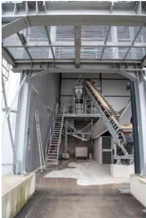
Figure 19 : centrale à béton de chanvre
